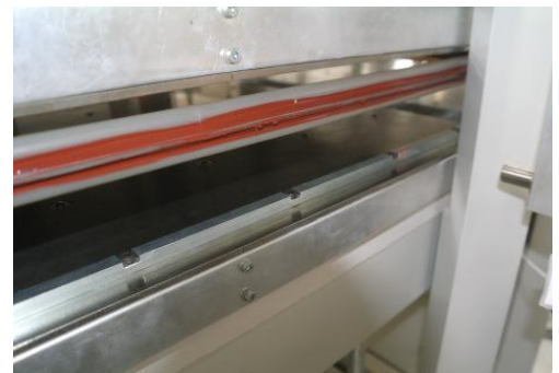
Vacuumframe in Hot Press
